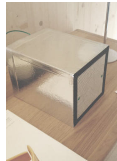
Abb. 112 | dezentrales Lüftungsgerät mit integrierter Wärmerückgewinnung
