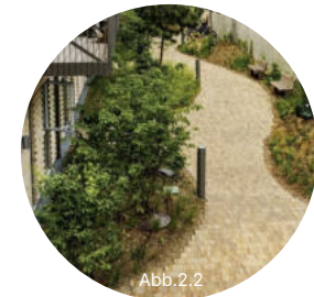
taktile Leitung durch harte / weiche Kante
